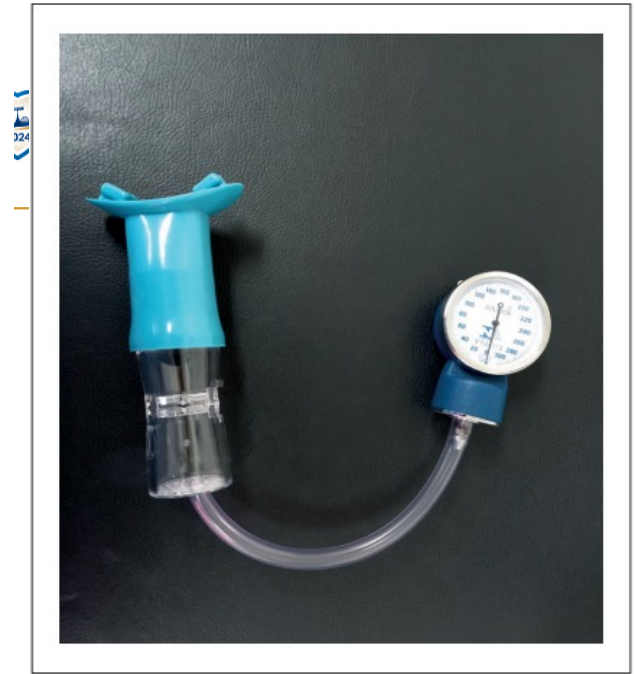
Figura 2 – Aparelho simples para avaliação da pressão intraoral durante a manobra de Valsalva, composto por um manômetro conectado a um tubo bucal. Imagem cedida por Julio Cesar Crescencio da Faculdade de Medicina de Ribeirão Preto - Universidade de São Paulo.
